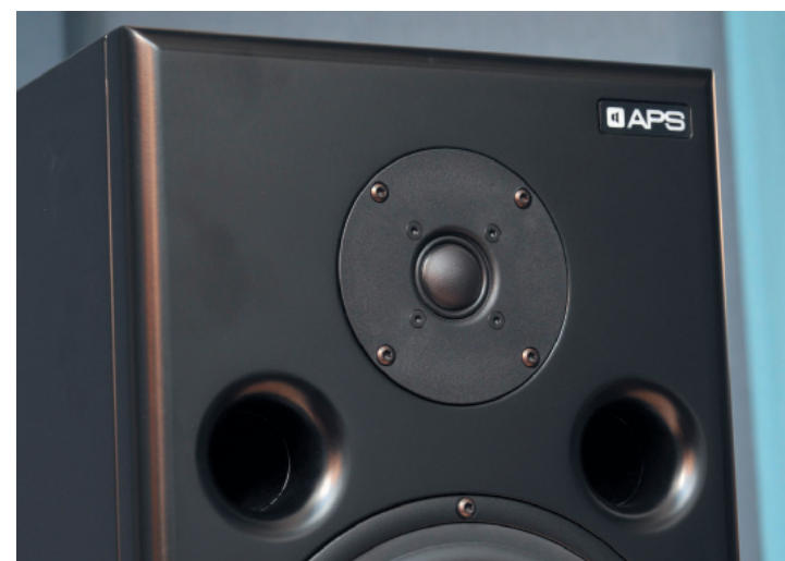
25-mm-Gewebekalotte ohne Schallführung. Darunter angeordnet die Bassreflexstapel mit gerundeten Auslässe zur Reduzierung der Strömungsgeräusche.
